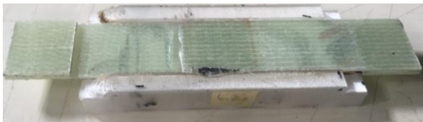
Şekil 2. Yapışma bağlantısının üretildiği kalıp.
